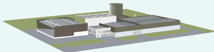
**Le Pôle de Valorisation des Déchets Résiduels** permet de convertir 81% des déchets dits «non recyclables» en C.S.R. (Combustibles Solides de Récupération) et en gaz injecté dans le réseau.
