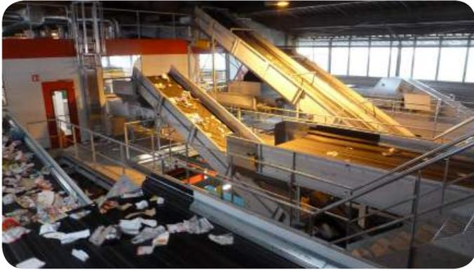
Le **centre de tri** a pour but de valoriser la part d'emballages provenant de la collecte sélective. Il permet de trier les emballages afin de pouvoir les recycler grâce à des filières spécialisées. Sa capacité maximale est de 11 000 tonnes/an d'emballages.
