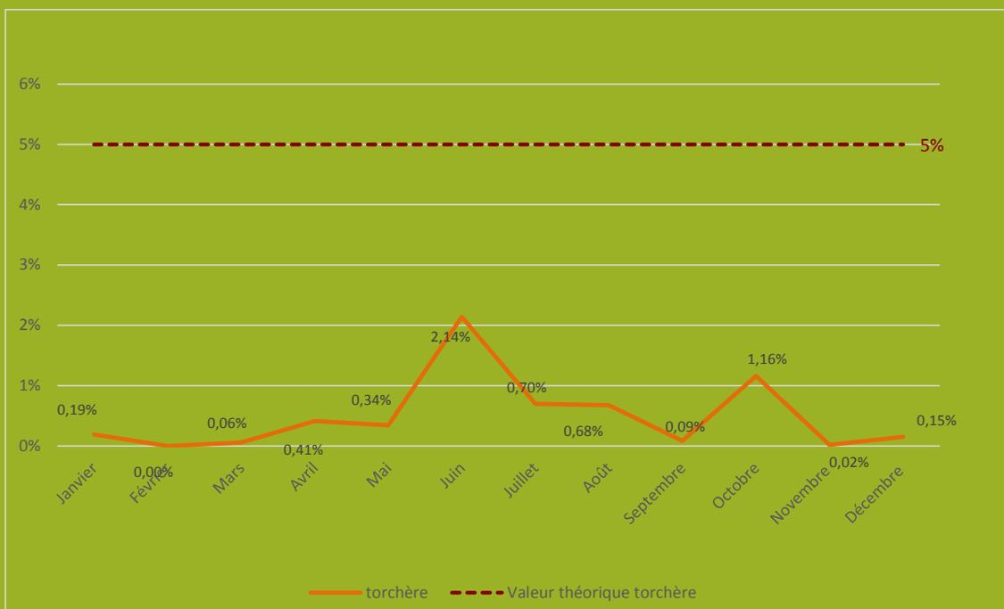
En 2015, la part de biogaz envoyée vers la **torchère** est passée en dessous de la valeur théorique puisqu'elle est, en moyenne, de 0,49 %. En 2013, elle était de 2,02 %, ce qui montre une nette progression de la valorisation du biogaz sous forme d'électricité et de chaleur puisque le biogaz n'est presque plus torché.
