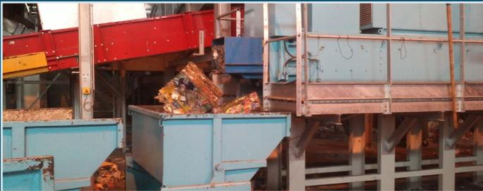
Une fois le tri mécanique réalisé, les déchets sont dirigés vers la cabine de tri où les valoristes vont séparer les matériaux par catégorie.
