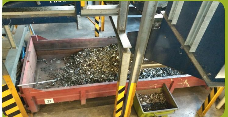
Le **structurant excédentaire** ou **refus d'affinage** correspond à la partie du compost contenant une grande quantité de plastiques et de copeaux de bois. Ce refus d'affinage est obtenu après criblage dans un trommel à mailles de 12 mm. Cette fraction constitue 22,27 % du tonnage entrant et sera ensuite envoyée en CSDND afin de servir de couche intermédiaire dans les alvéoles de stockage. Au final, entre 2014 et 2015, la matière totale évacuée a baissé de **16,71 %**.
