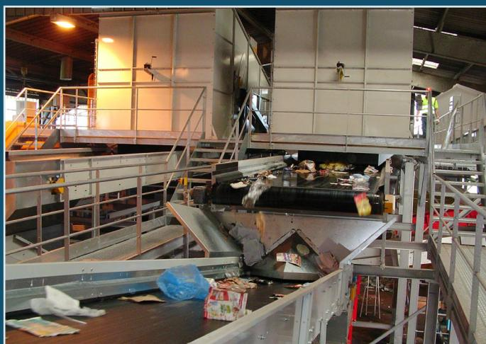
Ensuite, les corps creux vont passer sur une table vibrante afin d'y être bien séparés avant de subir un tri optique qui permet de trier le plastique en fonction de sa couleur et de sa matière (P.E.T, P.E.H.D,...)
